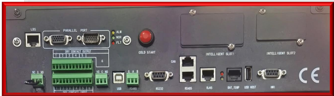
Puertos comunicaciones – Contactos Secos – EPO (Apagado Emergencia).
