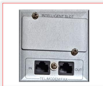
Slot para conexión SNMP y protección Modem.
