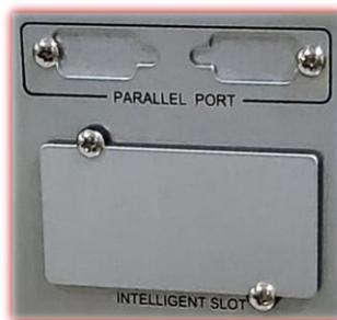
Slot para conexión Paralelo y SNMP.
