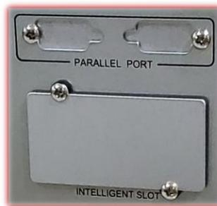
Slot para conexión Paralelo y SNMP.
